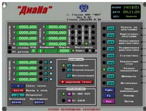
Рис. 6. Доступ к функциям и информационным ресурсам в системе ЧПУ «Диана-СНС» для отдельных аспектов процесса эксплуатации ограничен
