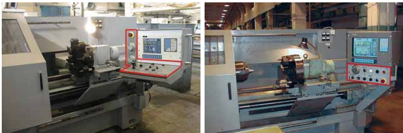
Рис. 4. Пример неэффективной модернизации: из-за несогласованных действий различных аспектов эксплуатации одинаковые станки имеют разные органы управления
