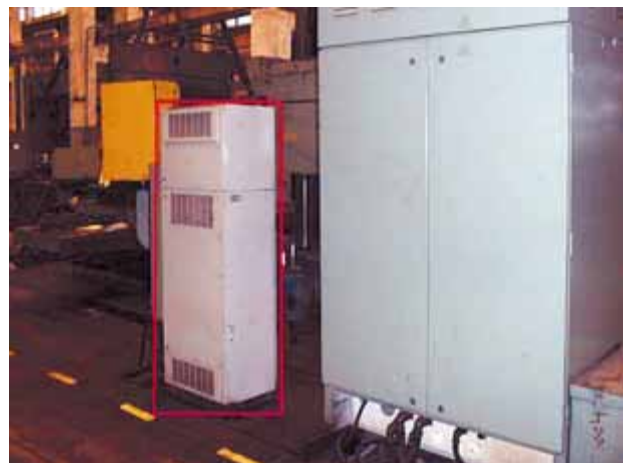
Рис. 3. Пример неэффективной модернизации: из-за несогласованных действий различных аспектов эксплуатации пришлось оставить значительную часть старой системы ЧПУ
